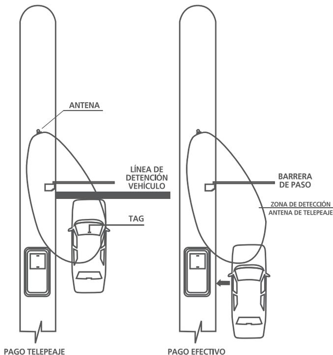
La Concesionaria dispondrá de la señalética adecuada en cada Vía Mixta de Telepeaje de Plazas de Peaje Troncal (Quinta y Río Maipo) y Lateral para indicar al Cliente la posición final que debe tomar el Vehículo en el Punto de Cobro Electrónico, para que la antena de Telepeaje pueda generar la transacción electrónica con el Dispositivo TAG del Vehículo.
